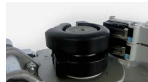
Finecorsa con regolazione di precisione
