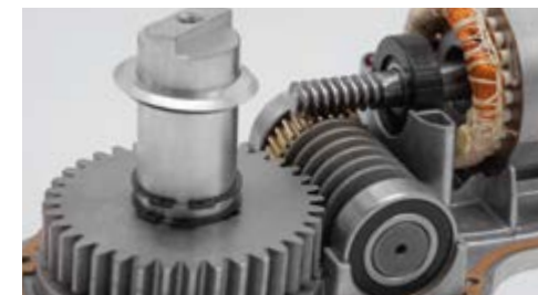
Ingranaggi completamente metallici
